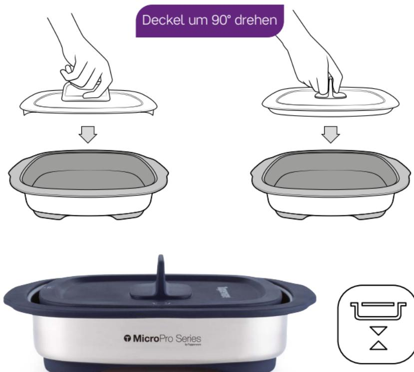
3. Platzieren Sie den **MicroPro Grill** in der Mikrowelle **maximal 20 Minuten bei maximal 1.000 Watt**
